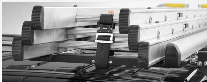
Verstellbarer Riemen und Schnalle Leiterbefestigung am Heck
